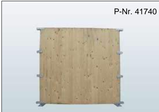
Sichtschutz-Zaun Typ M aus Holz B/H: 2000 x 1910 mm, Holzstärke 20 mm Gewicht: 44 kg
