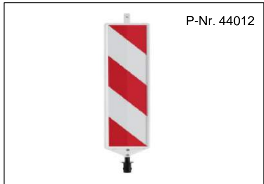
Leitbake Typ W 0,29 x 1,33 m mit Drehadapter HDPE Kunststoff, Farbe weiß-rot, Folie RA1 beidseitig 245x1000 mm, Gewicht 3,8 kg
