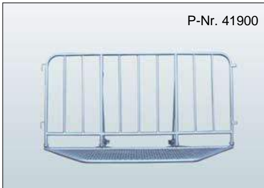
Polzeigitter Typ M - 1,08 x 2,17 m klappbar, Rohr Außen Ø: 33 mm, Rohr Innen Ø: 21 mm, Gewicht: 53 kg
