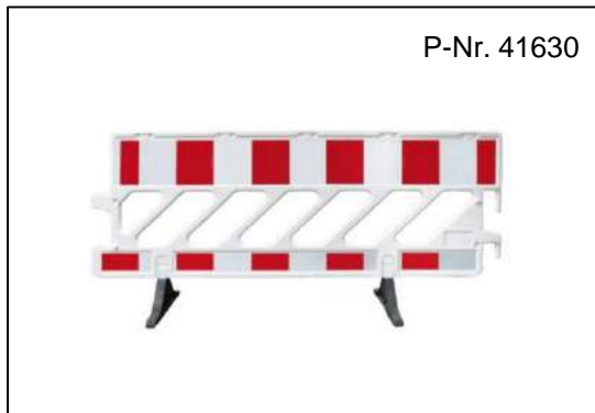
Absperrzaun Typ N - 1,05 x 2,00 m HDPE Kunststoff, Farbe weiß-rot, Folie einseitig, FüÙe drehbar, Gewicht: 15 kg
