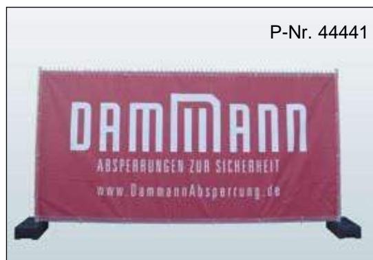
Sichtschutz-Netz Typ BNW B/H: 3410 x 1760 mm, PP-Gewebe, 150g/m 2 , alle 500 mm geöst, mit Werbung bedruckbar
