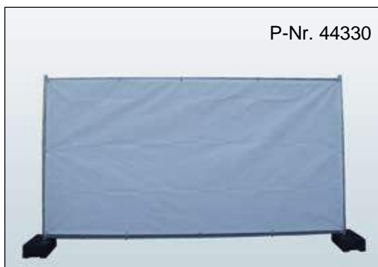
Sichtschutzplane Typ AWB1 B/H: 3410 x 1760 mm, PE-Bändchengewebe, Farbe weiß, 260g/m 2 , alle 500 mm geöst, B1
